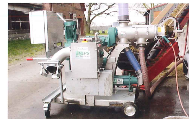
ComPress avec broyeur séparateur intégré, pour la protection de la technologie de pompes et d'installations, produit de la litière pour les élevages bovins. ComPress con mulino separatore integrato per garantire la protezione del sistema di pompaggio e di separazione. Installato in impianto di produzione di lettiera per bovini.
