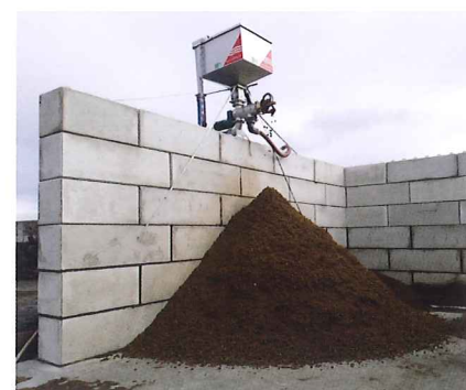
Lisier brut avec env. 6,5 % de matière sèche pressé à 20 % de matière sèche pour un débit d'env. 7 m 3 par heure. Il liquame tal quale con circa il 6,5% di SS viene portato ad un contenuto del 20% di SS mediante separazione (7 metri cubi ora).
