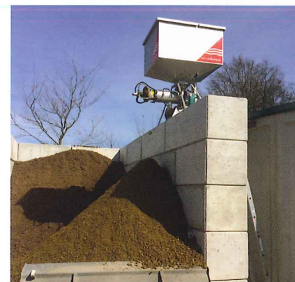
Lisier brut avec env. 6,5 % de matière sèche pressé à 20 % de matière sèche pour un débit d'env. 7 m 3 par heure. Il liquame tal quale con circa il 6,5% di SS viene portato ad un contenuto del 20% di SS mediante separazione (7 metri cubi ora).
