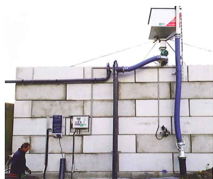
Sur cet élevage bovin, le séparateur est installé sur un mur en béton pour collecter les substances solides qui se trouvent en dessous. Il separatore è stato installato sulla sommità di questo muro per consentire l'accumulo del separato solido direttamente in trincea.
