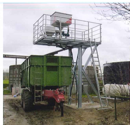
Ce PSS 2.2-400 avec récipient de collecte est installé dans un élevage porcin avec env. 5 % de matière sèche dans le lisier brut. La benne basculante est remplie en env. 1,5 jour. Questo PSS 2.2-400 con serbatoio polmone viene installato in un allevamento di suini da ingrasso con circa il 5% di sostanza secca nel liquame tal quale. Il rimorchio ribaltabile viene riempito con il materiale di separazione dopo circa 1,5 giorni.
